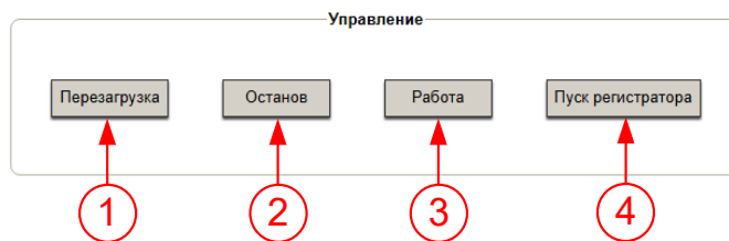
Рисунок 46 – Элементы блока управления регистратором
