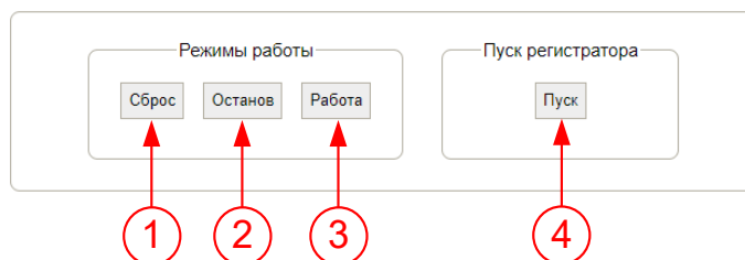
Рисунок 18 – Элементы блока управления регистратором
